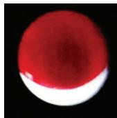
3. Si tenga in posizione l'elemento ottico. Nel caso che sia necessario riposizionare l'elemento ottico, ciò può essere fatto semplicemente muovendolo lungo il canale dell'elemento ottico fino a vedere di nuovo la forma a mezzaluna.
