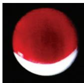
3. L'élément optique est en place. Si nécessaire, il est possible de repositionner l'élément optique en le déplaçant le long du canal optique jusqu'à ce que la forme de croissant apparaisse à nouveau.
